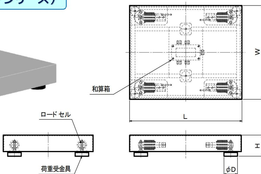
本体:SS製 塗装仕上 / 天板カバー式:SUS製バフ仕上#300 (BFP-SPシリーズ)
